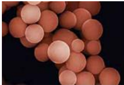
Scansione al microscopio elettronico dell'aerogel di silice (silice amorfa)
